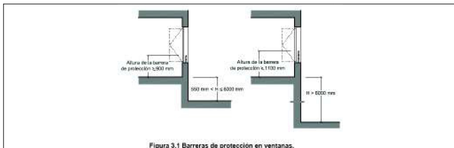
Figura 3.1 Barreras de protección en ventanas.
